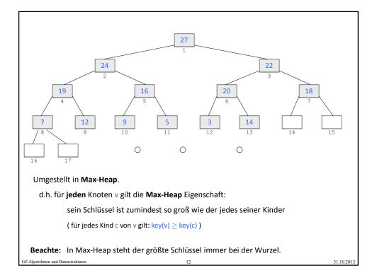
Beachte: In Max-Heap steht der größte Schlüssel immer bei der Wurzel.
